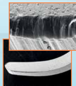
Ostří běžné nepotažené kyrety a jeho zvětšení po testování.
