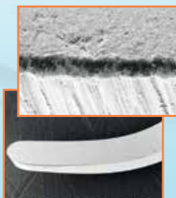
Ostří kyrety LM Sharp Diamond™ a jeho zvětšení po testování.
